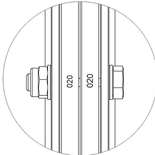
**Anziehdrehmoment für die Schraube M12 Pos.(3, 5):  $60 \pm 2$  Nm**
