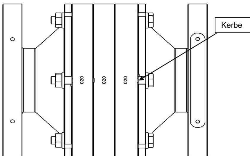
**Anziehdrehmoment für die Schrauben M8 Pos.(2, 3) : 20±2 Nm**
