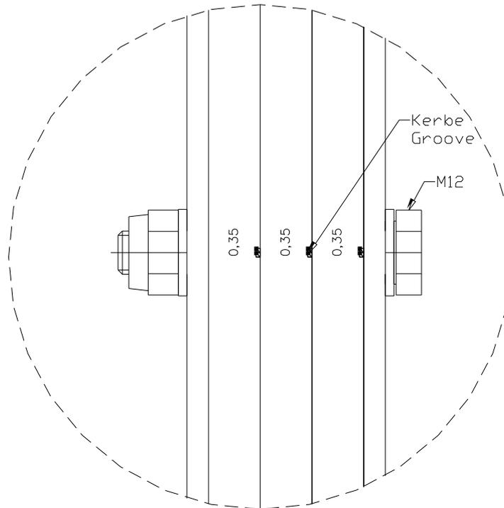
**Anziehdrehmoment für die Schraube M12 Pos.(7) :  $60 \pm 2$  Nm**
