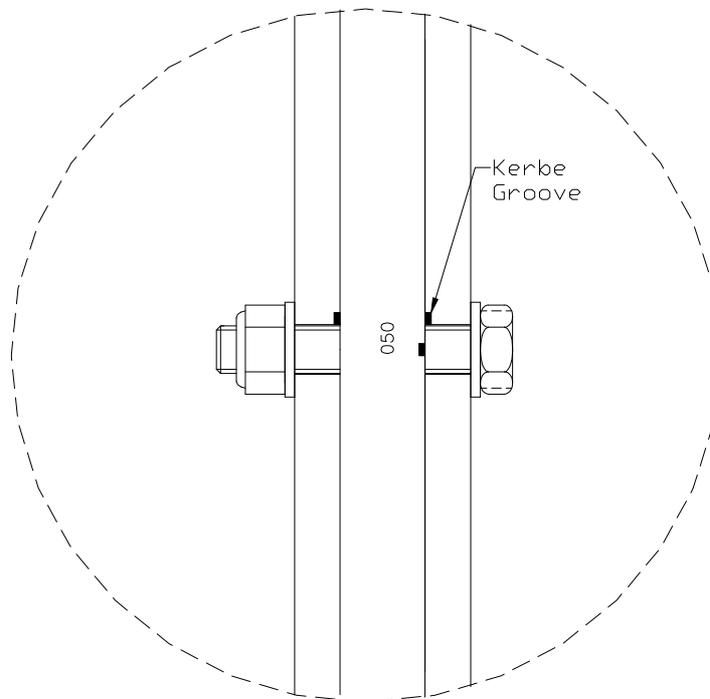
**Anziehdrehmoment für die Schrauben M8 Pos.(2, 5) :  $20 \pm 2$  Nm**
